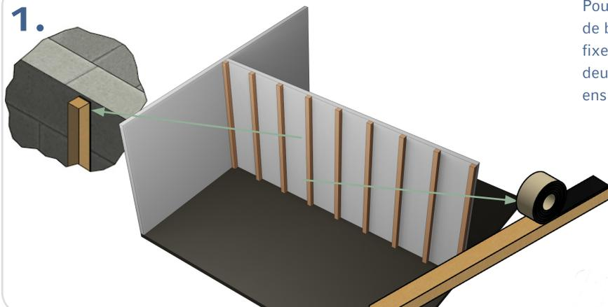
Pour éviter un pont acoustique entre les lattes de bois et le mur, nous recommandons de fixer notre bande d'étanchéité soni NBR des deux côtés des lattes de bois et de les cheviller ensuite au mur.
